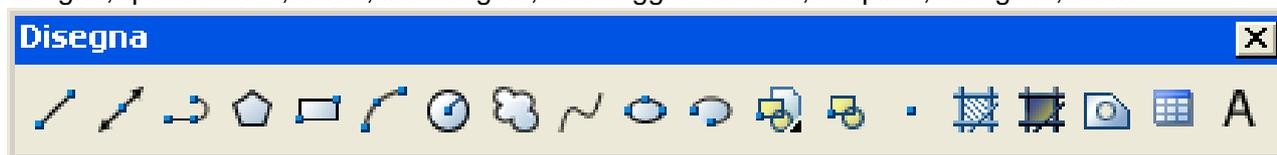
Fig. 18 Barra degli strumenti Disegna. Tutte le principali funzioni di disegno sono contenute in questa barra degli strumenti..
